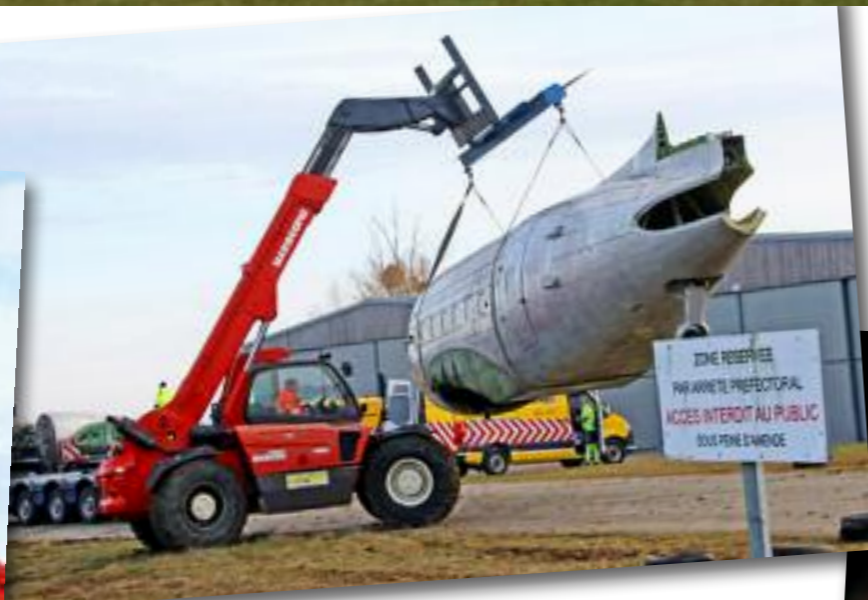
Démontage des voilures, des moteurs, puis du plan central...
