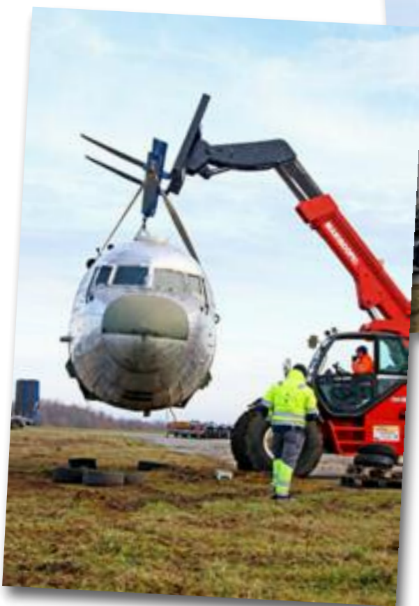
Démontage des voilures, des moteurs, puis du plan central...
