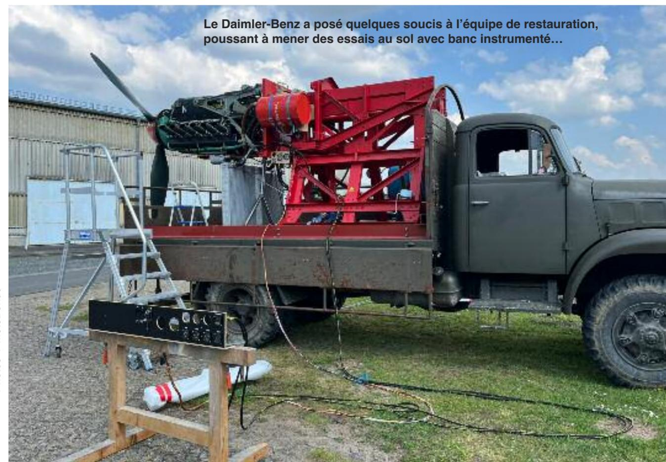
Le Daimler-Benz a posé quelques soucis à l'équipe de restauration, poussant à mener des essais au sol avec banc instrumenté...
