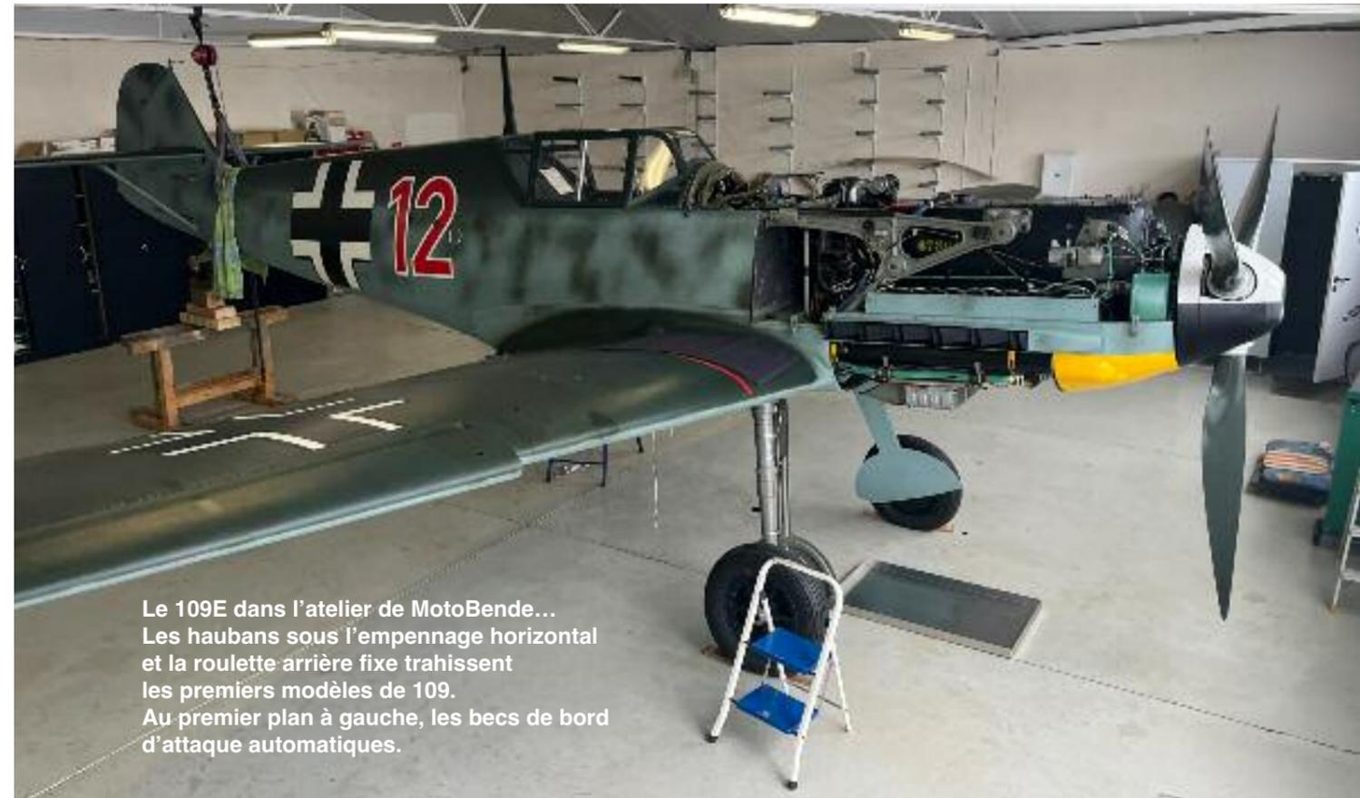
Le 109E dans l'atelier de MotoBende... Les haubans sous l'empennage horizontal et la roulette arrière fixe trahissent les premiers modèles de 109. Au premier plan à gauche, les bords d'attaque automatiques.
