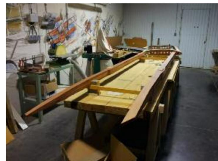
Avec quatre longerons neufs, les ailes ont été entièrement refaites pour redonner une capacité Voltige au SV-4C même si le 4PO3 n'est pas alimenté dos.
