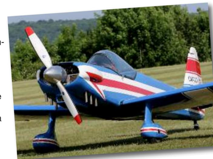
Avec deux réservoirs de 43 litres, l'autonomie du 20/260 est comptée à raison de 70 l/h en moyenne...
